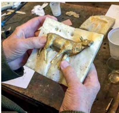
Tak powstaje forma jelenia – poroże jest robione oddzielnie
